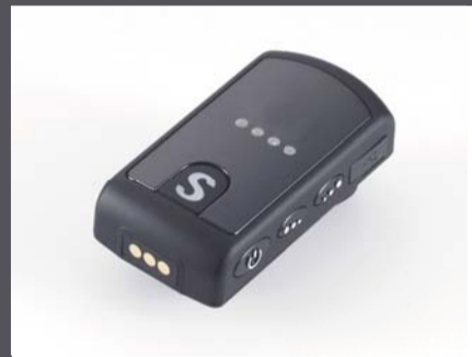
อุปกรณ์เป็นทั้งภาครับและภาคส่งในตัวเดียวกัน (Master/Slave)
